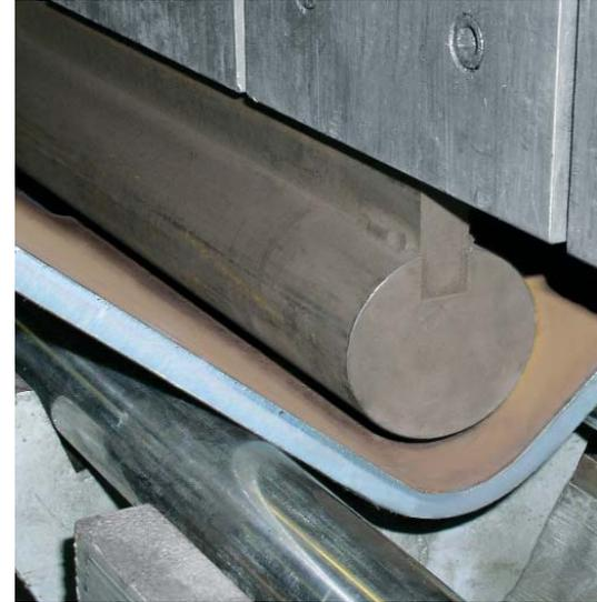
günstigeres Rissauslösungsverhalten und Rissauffangvermögen auf als ein dickeres. Es wird vorausgesetzt, dass die Blechkanten vor dem Umformen kerbfrei geschliffen und entgratet sind. Außerdem ist auf ein gutes Gleiten der Bleche zu achten, d. h. auf Schmierung der Matrize und des Biegestempels sowie auf ständiges Säubern der Werkzeuge von losem, abgeblättertem Glühzunder.
